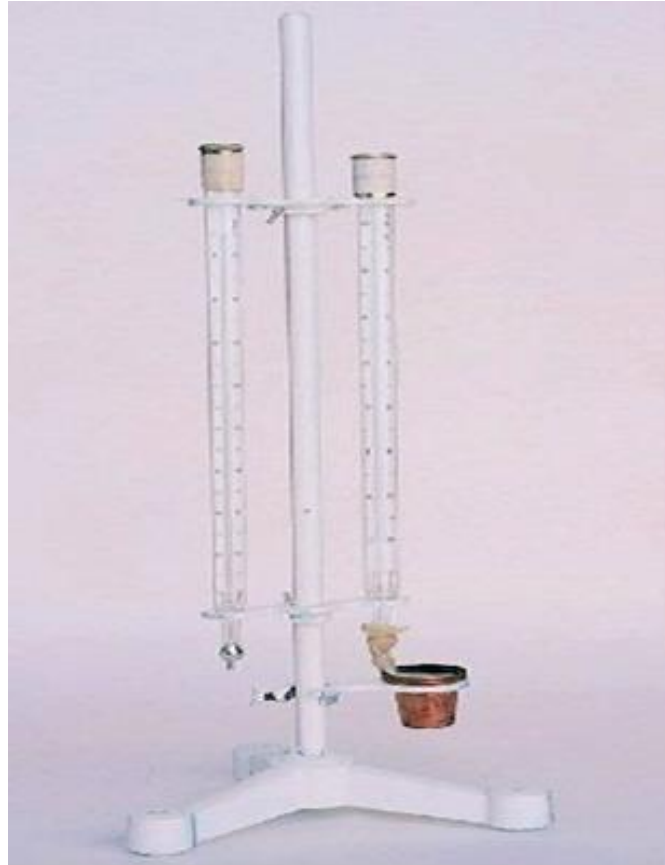
Figura 7.9. Psicrômetro de ventilação natural. Fonte: http://www.ufjf.br/labcaa/equipamentos/
