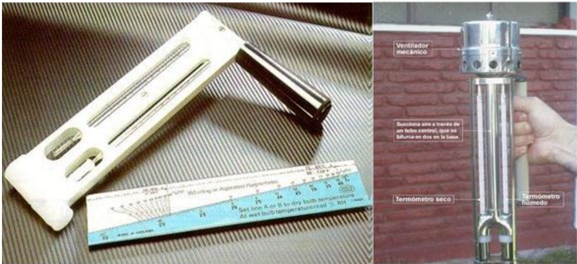
Figura 7.10. Psicrômetro de funda (esquerda), cuja ventilação é obtida fazendo-se girar o suporte dos termômetros, e, psicrômetro Assmann (direita), com aspirador mecânico embutido na parte superior. Fonte: www.leb.esalq.usp.br/leb/aulas/leb495/Aula_4.pdf .
