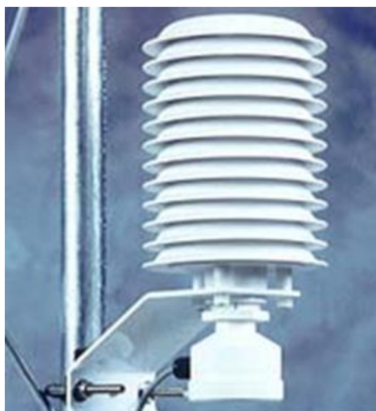
Figura 7.15. Abrigo meteorológico – estação automática. Fonte: Sentelhas & Angelocci (2009).
