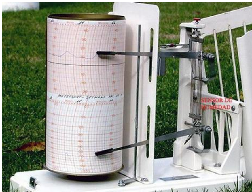
Figura 7.13. Termohigrógrafo com sensores conjugados de temperatura e umidade do ar. Fonte: http://www.nevasport.com/meteo/art/9467/El-Termohigrografo/ .
