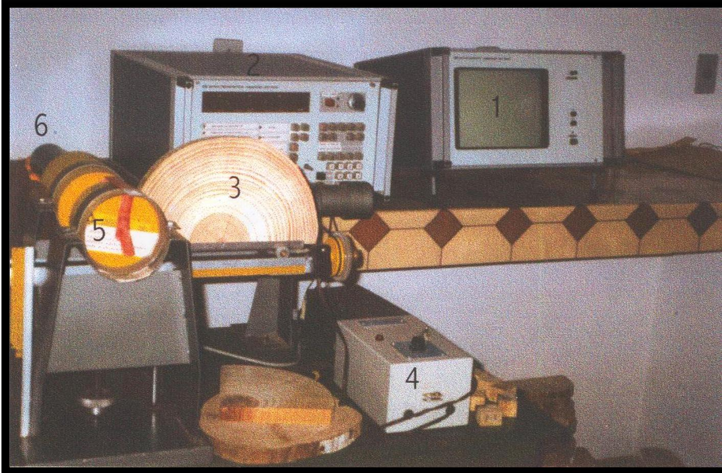
Instrumento de detecção de radiação gama por  $^{241}\text{Am}$
