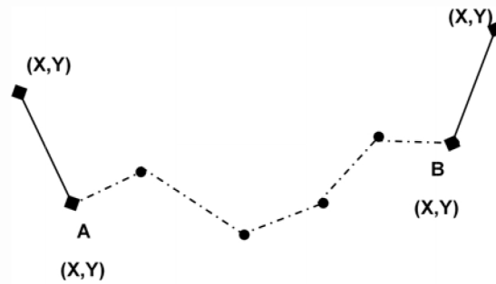
Figura 1 – Exemplo de poligonal apoiada em duas bases
